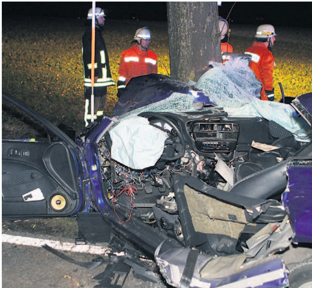
Mit schweren hydraulischen Rettungssätzen trennten die Rettungskräfte das Dach des Hondas ab. fn
